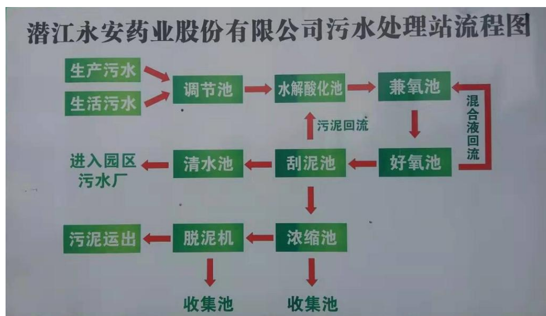
图3.6-1 污水处理工艺流程图
